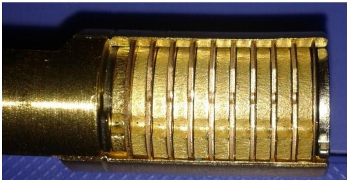
**Fig 3. Le palpeur se déplace dans l'espace de la rondelle pour atteindre le disque suivant (les disques et la rondelle devant le palpeur sont retirés)**
