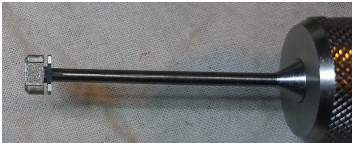
**Fig 14. Poignées alignées pour le décodage de la tension arrière**
