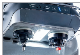
Éclairage led avec capteur de proximité
